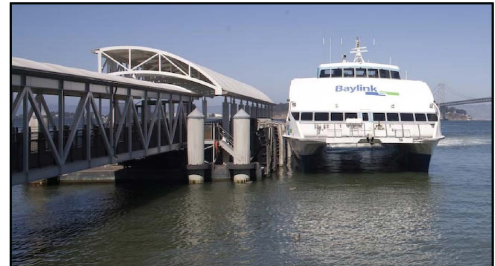
(d) Catamaran passenger ferry (San Francisco)
