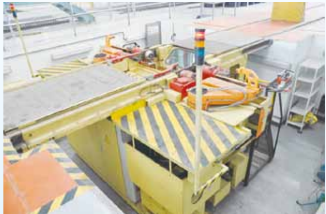
圖 5-8 車輪車床的設備（高雄捷運南機廠）
