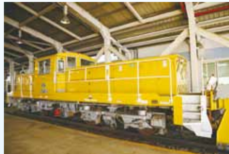
圖 5-5 台北捷運（電力／電瓶式）維修用機車頭
