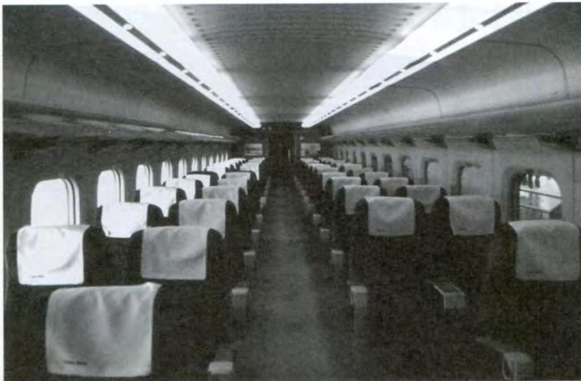
圖 4-12 日本新幹線 700 系採用雙面鋁擠型中空面板結構，座艙似飛機（蘇昭旭 攝）
